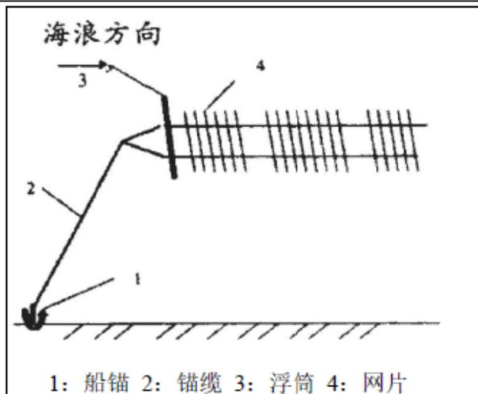
图 1.4-4 养殖筏架结构示意图
